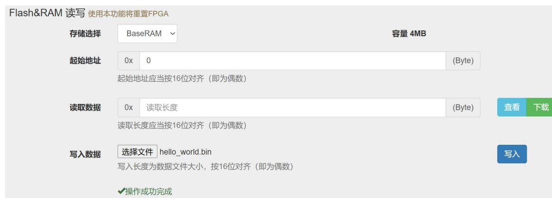
图 2-14 远程 FPGA 下载 SRAM
